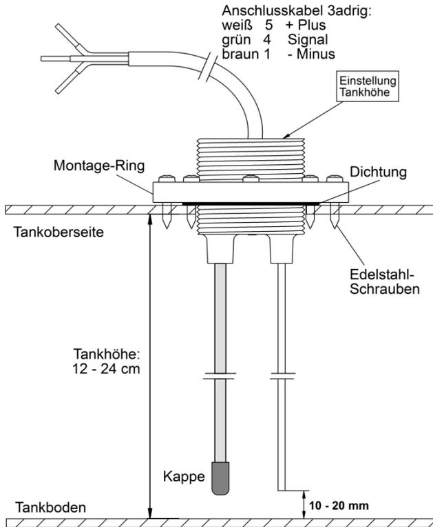
Nun die Tankhöhe durch die Montagebohrung messen (Zollstock o.ä.) und beide Stabsonden auf gleiche Länge kürzen (Metallsäge, kräftiger Seitenschneider, Bolzenschneider).
