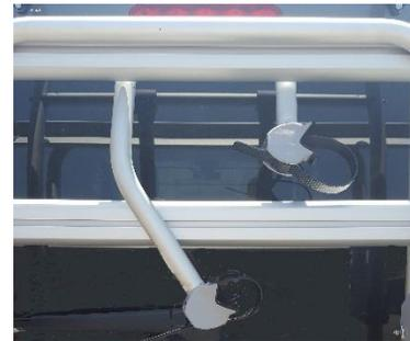
Der Schienenträger (2) des EuroCarry lässt sich in unbeladenem Zustand hochklappen. Mit dem Zurrriemen bitte extra sichern. Zusätzlich können die Fahrradgreifarme (3 + 4) heruntergeklappt werden (Abb. l)
