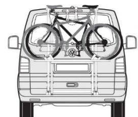
Bei der Lenker- und Pedalstellung des ersten (fahrzeugnächsten) Fahrrades ist der notwendige Freiraum zur Fahrzeugrückwand zu berücksichtigen.
