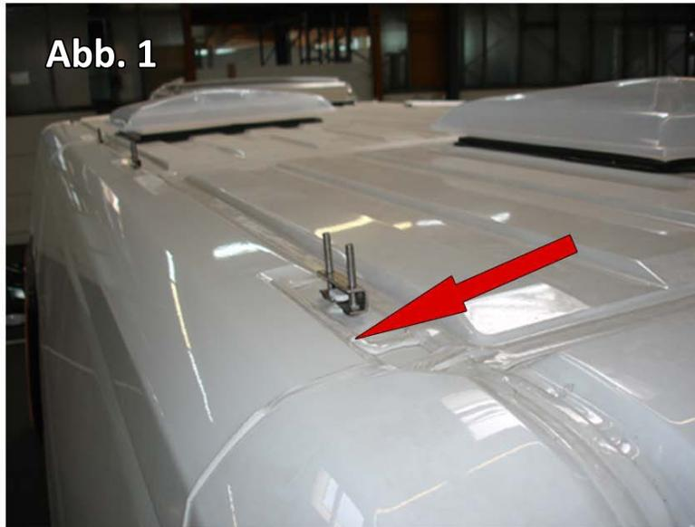
Nachdem Sie Ihr Fahrzeug gereinigt und das zusätzliche Montagematerial gekauft haben, kann die Montage der STYLE Reling beginnen. Im 1. Schritt werden die Gewindekrallen in die am Dach vorhandenen Haltezapfen eingeschoben (**Abb. 1** - Pfeilrichtung bitte beachten).
