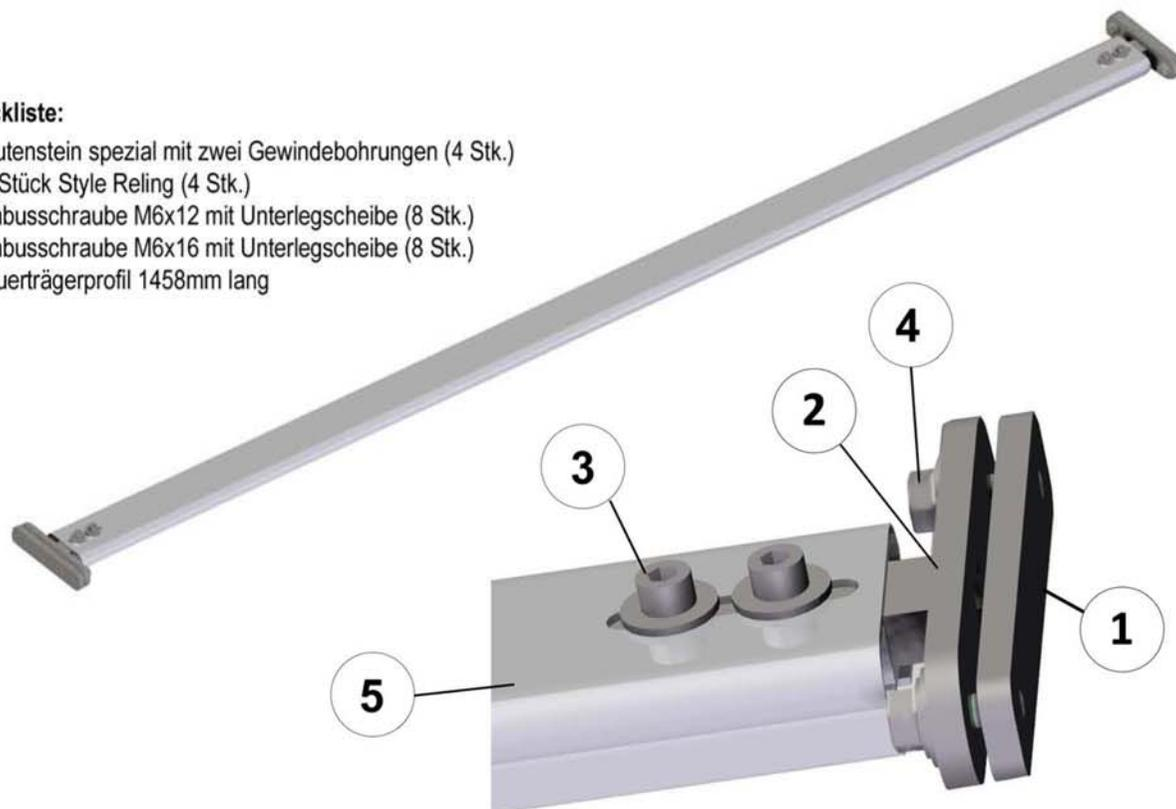
Die Montage der Querträger ist einfach durchzuführen. Entnehmen Sie die Querträger der Verpackung und legen Sie die Nutensteine (POS. 1) in die in der Reling dafür vorgesehene Nut ein. Schieben Sie die Nutensteine an die gewünschte Position, an der später der Querträger sitzen soll.
