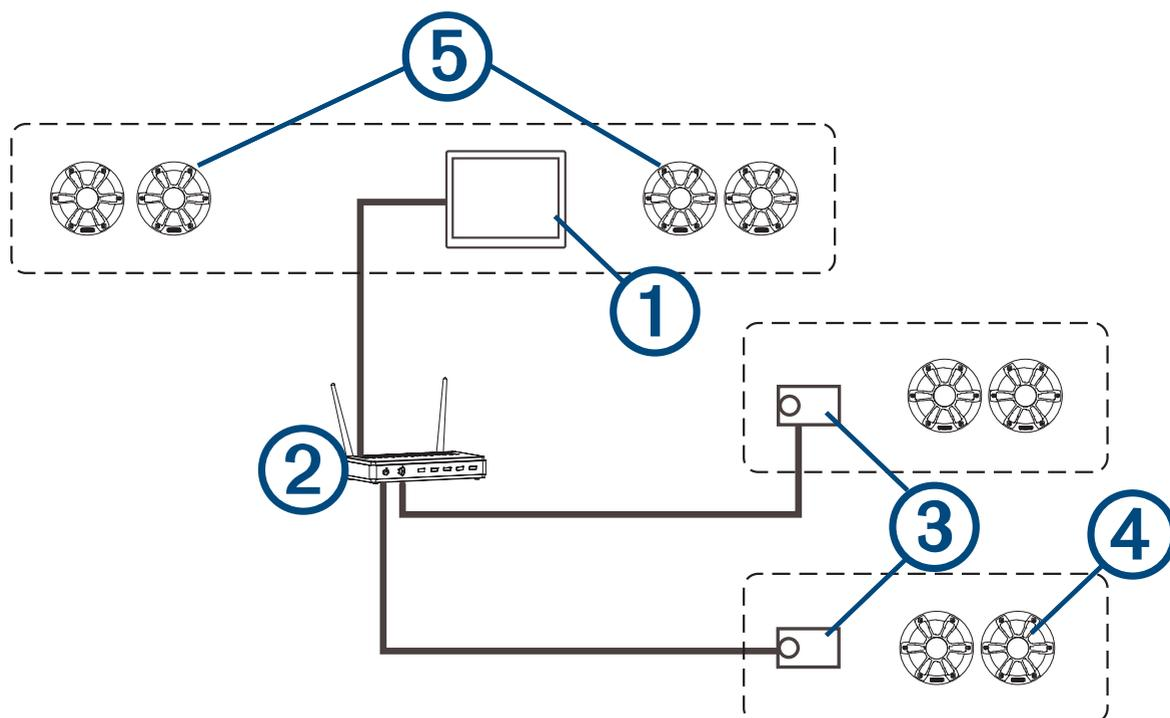
In der oben dargestellten Abbildung ist ein Vioo RV 850 Radio ① mit einem WLAN-Router ② und zwei Apollo SRX400 Zonenradios ③ verbunden. Die zwei Fusion PartyBus Stereo-Zonenradios können Quellen vom Fusion PartyBus Radio streamen.
