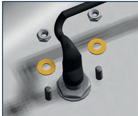
Diese sind dann mit den Beilagscheiben und den Sicherungsmuttern zu versehen. Anschließend kann der Schraubverband handfest angezogen werden.
