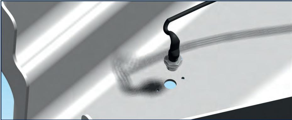
Anschließend wird von oben das Halteblech auf der Oberseite der Haube über den Gewindeansatz der Anzeige-LED geschoben.
