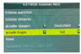
Wenn der alphatronics Fernseher an einer Hausanlage oder Multischalter betrieben werden soll, kann man die **KATHREIN Antennen Kontrolle** in der letzten Zeile mit den Pfeiltasten auf **AUS** stellen.
